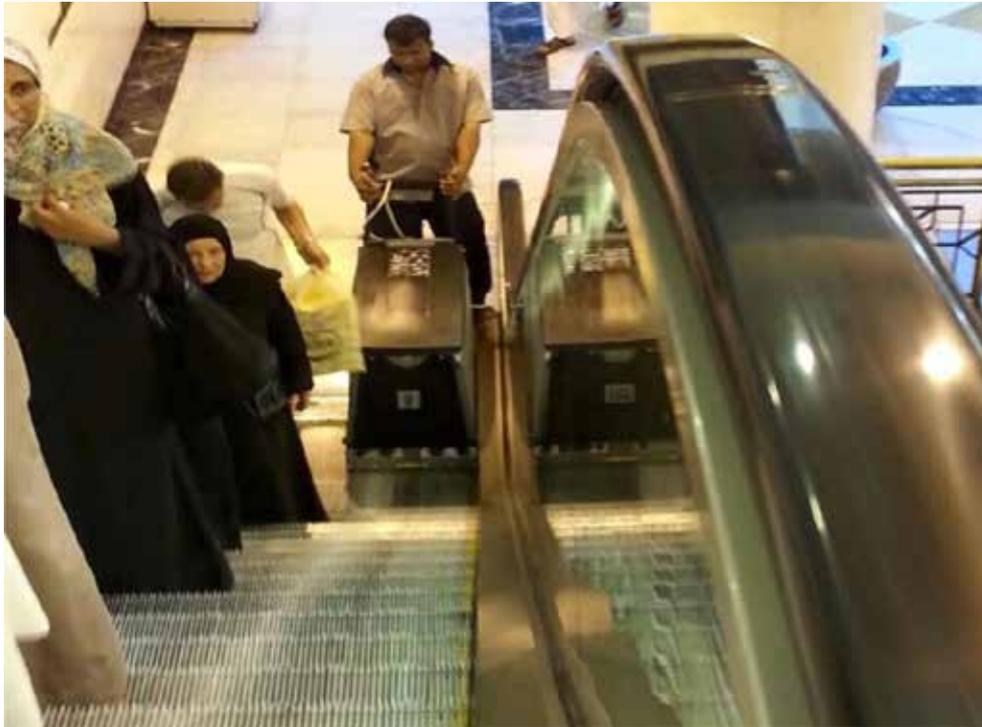
الماكينة الجديدة لتنظيف السلالم الكهربائية حديثة التركيب
